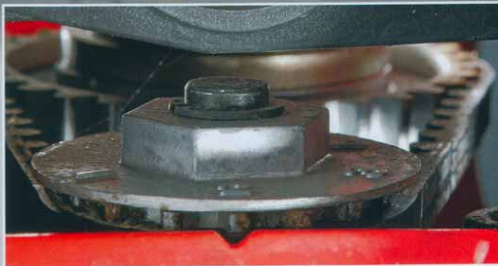
Zahn der Zeit: Dass in den frühen 80er-Jahren nicht unbedingt auf jeden Pfennig geschaut wurde, beweist die ebenso praktische wie aufwändige Federbasisverstellung des Zentralfederbeins mittels Schraube und Zahnriemen
