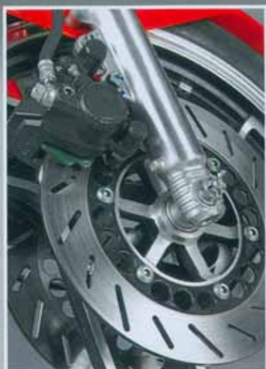
Damals eine der Besten: Die Doppelscheibe mit einfachen Schwimmsätteln beißt kräftig zu
