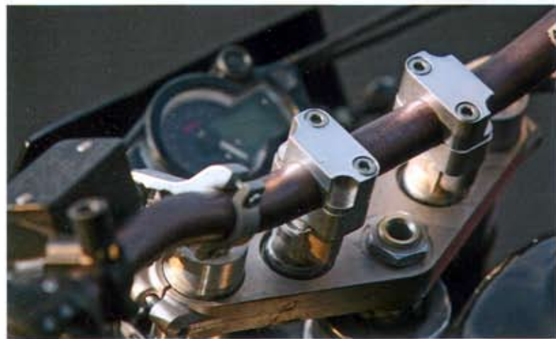
Lockeres Sitzen. Acerbis-Lenker mit Höherlegung aus dem Zubehörhandel
